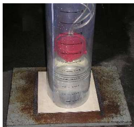
図 1.水充填垂直落下強度試験装置の一例
